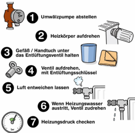
Abbildung 3: Heizung entlüften Schritt für Schritt (Bildquelle: heizsparer.de)
