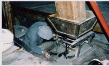
Auf dem mittleren Stockwerk prüft Rudolf Kunz das Einlaufen der Körner in den Mahlgang.
